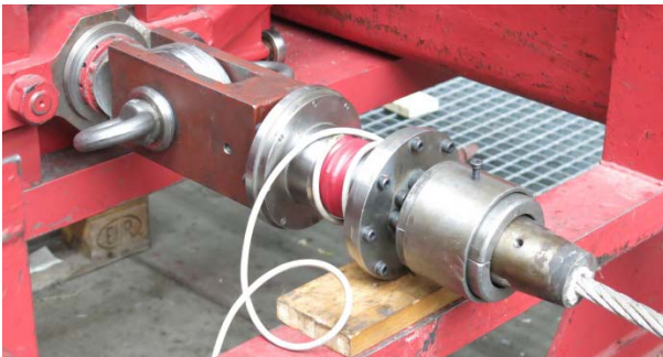
Abbildung 26: Aufbau Drehmomentbestimmung, Messrohrseite
