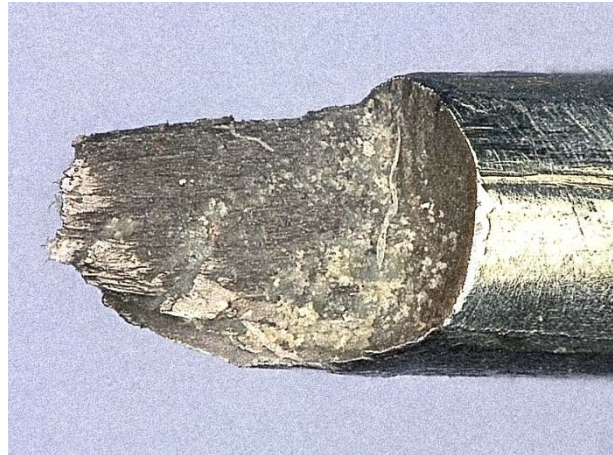
Dauerdrahtbruch bei -1080^{\circ}/100d
