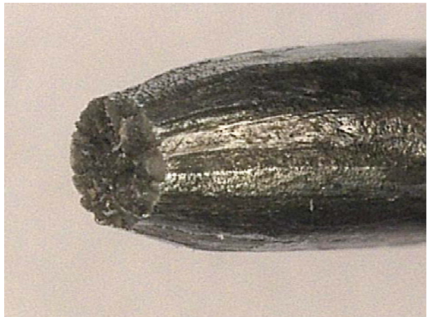
seltener Gewaltbruch mit Einschnürung bei +360^{\circ}/100d
