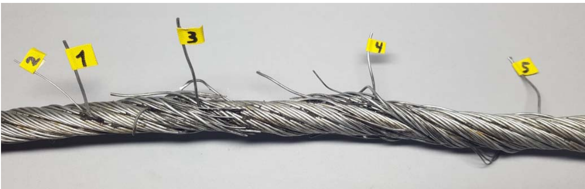
Abbildung 35: Versuchsende bei Litzenbruch, Drähte sind zur Mikroskopie markiert ( +1080^\circ/100d )
