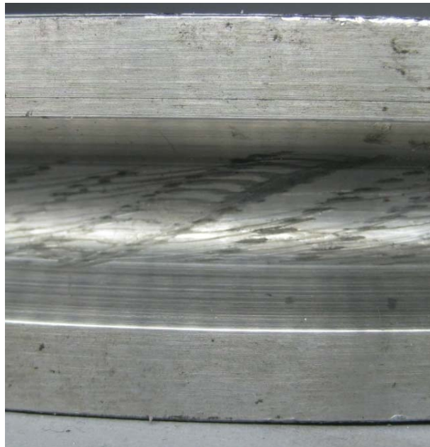
Abbildung 51: Abdruck eines Seils in der Scheibe eines Dauerbiegeversuchs am IFT
