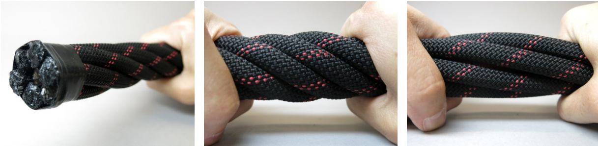
Abbildung 44: Seil-Handmodell der FMEA und Veranschaulichung verschiedener Verdrehzustände
