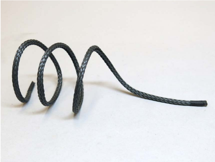
Abbildung 106: Beispiel des Ruhezustands eines verdrehten Faserseils in geflochtener Konstruktion (Kühner 2016)
