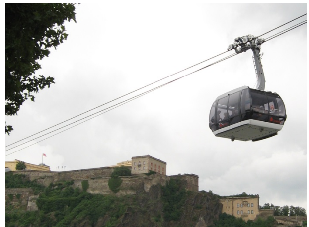
Abbildung 8: Dreiseilumlaufbahn (3S) Rheinseilbahn in Koblenz, Doppelmayr GmbH, Baujahr 2010
