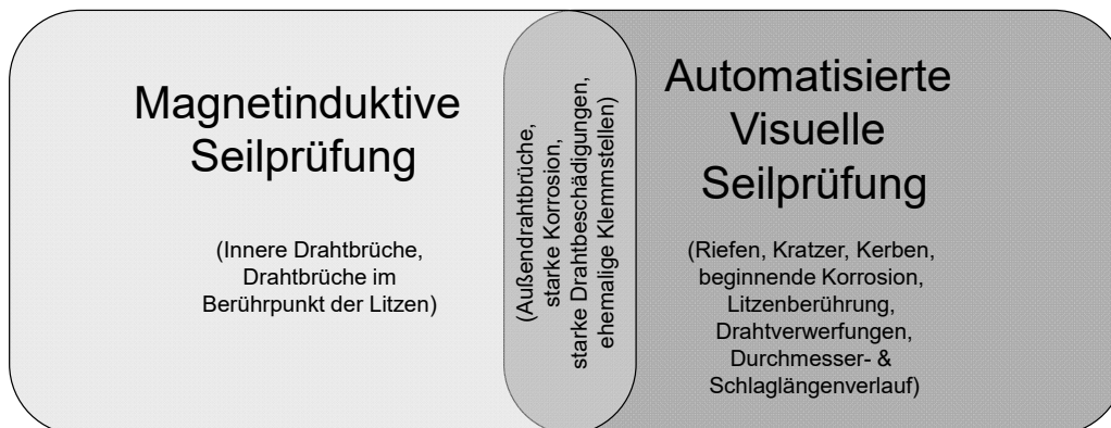
Abbildung 25: Übersicht der Prüftiefe der Methoden "magnetinduktiv" und "visuell" (Quelle: IFT)
