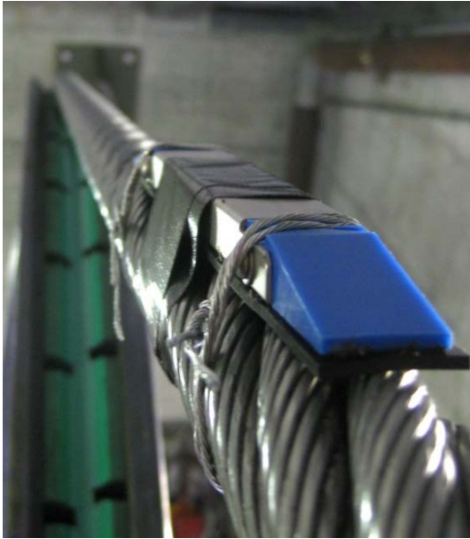
Montierter Drehsensor auf Zugseil der Transportbahn in Müren (CH)
