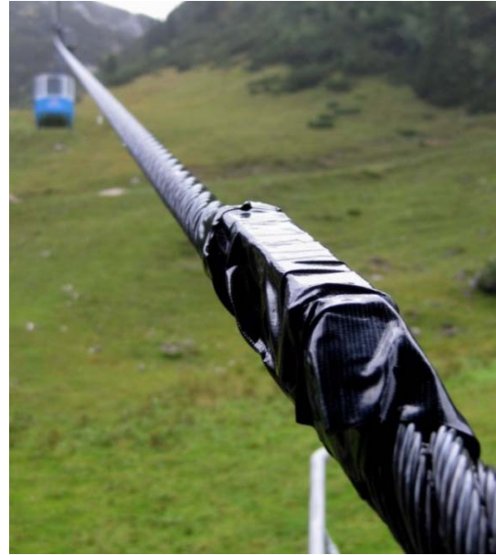
Drehsensor im Messbetrieb auf der Hochalmbahn, Garmisch-Partenkirchen
