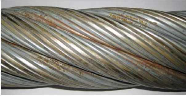
Abbildung 66: Korrosion in der Litzengasse eines Seilbahnförderseils durch mangelnde Schmierung
