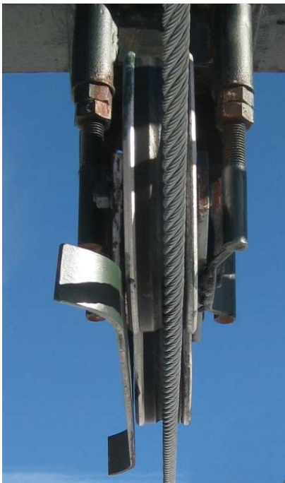
Abbildung 72: Rollenbatterie mit asymmetrischer Spur an einem Skilift im Spitzingsee-Gebiet
