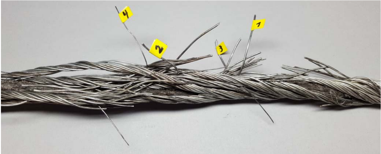
Abbildung 36: Versuchsende bei Litzenbruch, Drähte sind zur Mikroskopie markiert (-1080°/100d)
