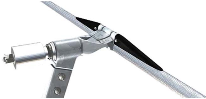
Abbildung 78: Vorbildkonstruktion einer im Betrieb nicht lösbaren Fahrzeugklemme, System Leitner
