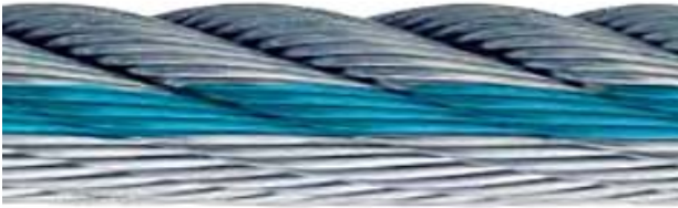
Abbildung 21: Farbmarkierung eines Drahtseils zur Überwachung der Verdrehung bei der Montage (Quelle: www.brugglifting.com )
