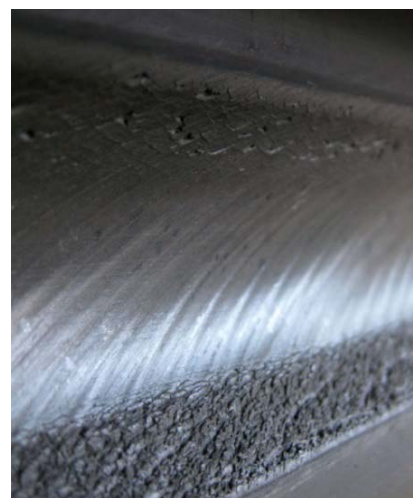
Beispiel des Spurbildes in einer nicht fluchtenden Rolleneinlage
