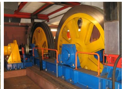
Stehender Pendelbahnantrieb mit doppelter Umschlingung
