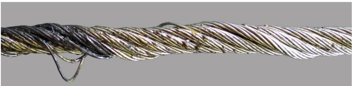
Abbildung 37: Versuchsende bei ausgebildetem Korkenzieher (+1080°/100d)
