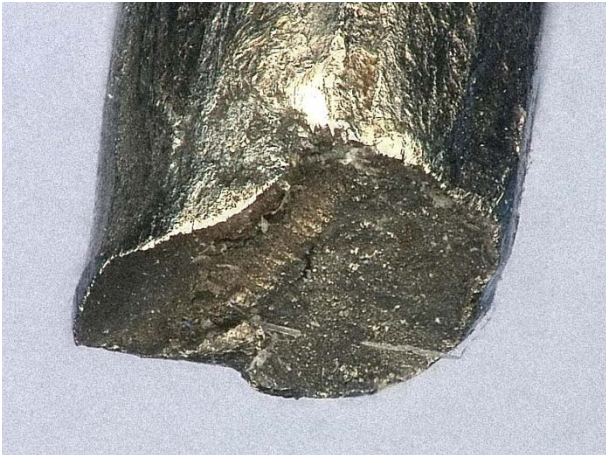
Dauerdrahtbruch bei -1080^{\circ}/100d
