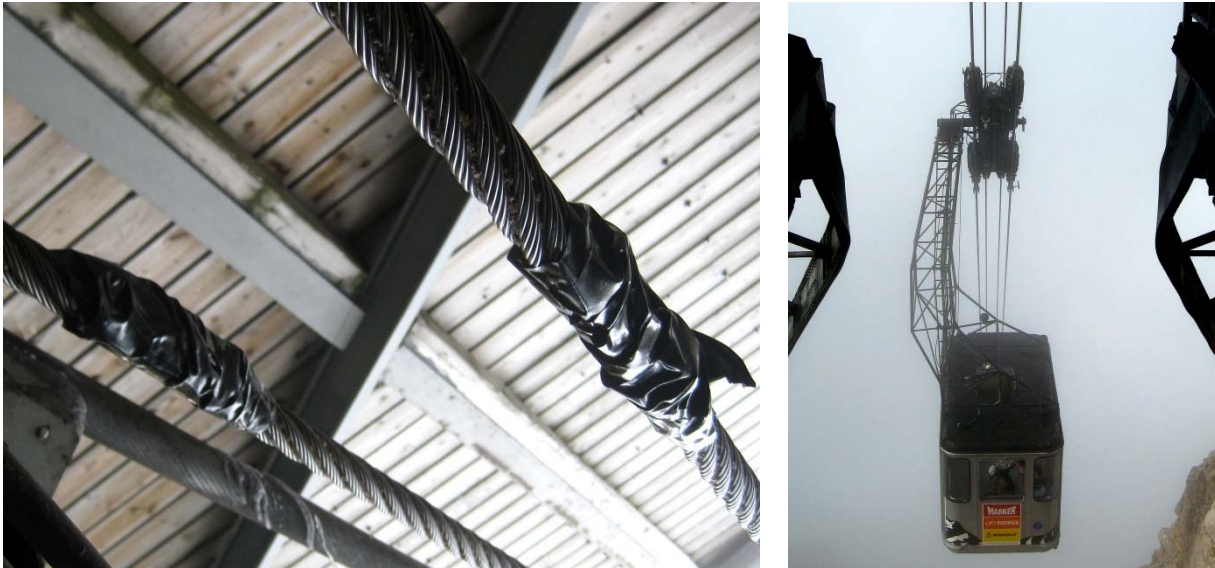
Abbildung 85: Messaufbau an einer Pendelbahn mit zwei parallelen Zugseilen
