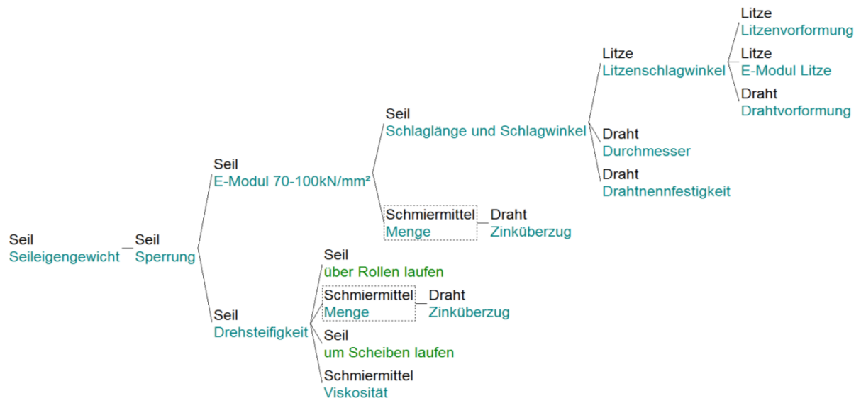
Abbildung 48: Ausschnitt des Funktionsbaums am Beispiel des Seils
