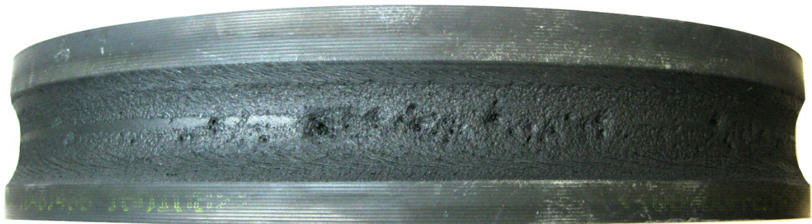
Abbildung 71: Rollen-Einlagegummi mit thermischem Versagensbild durch Überbelastung
