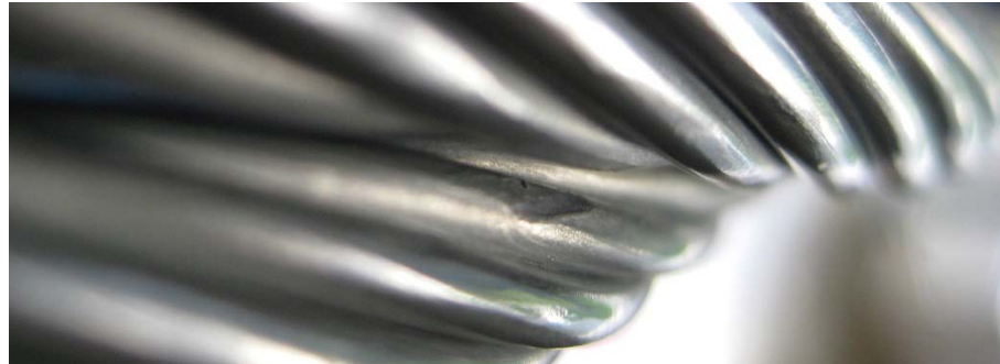
Abbildung 14: Kerbbildung an sich berührenden Litzen unter Verdrehung
